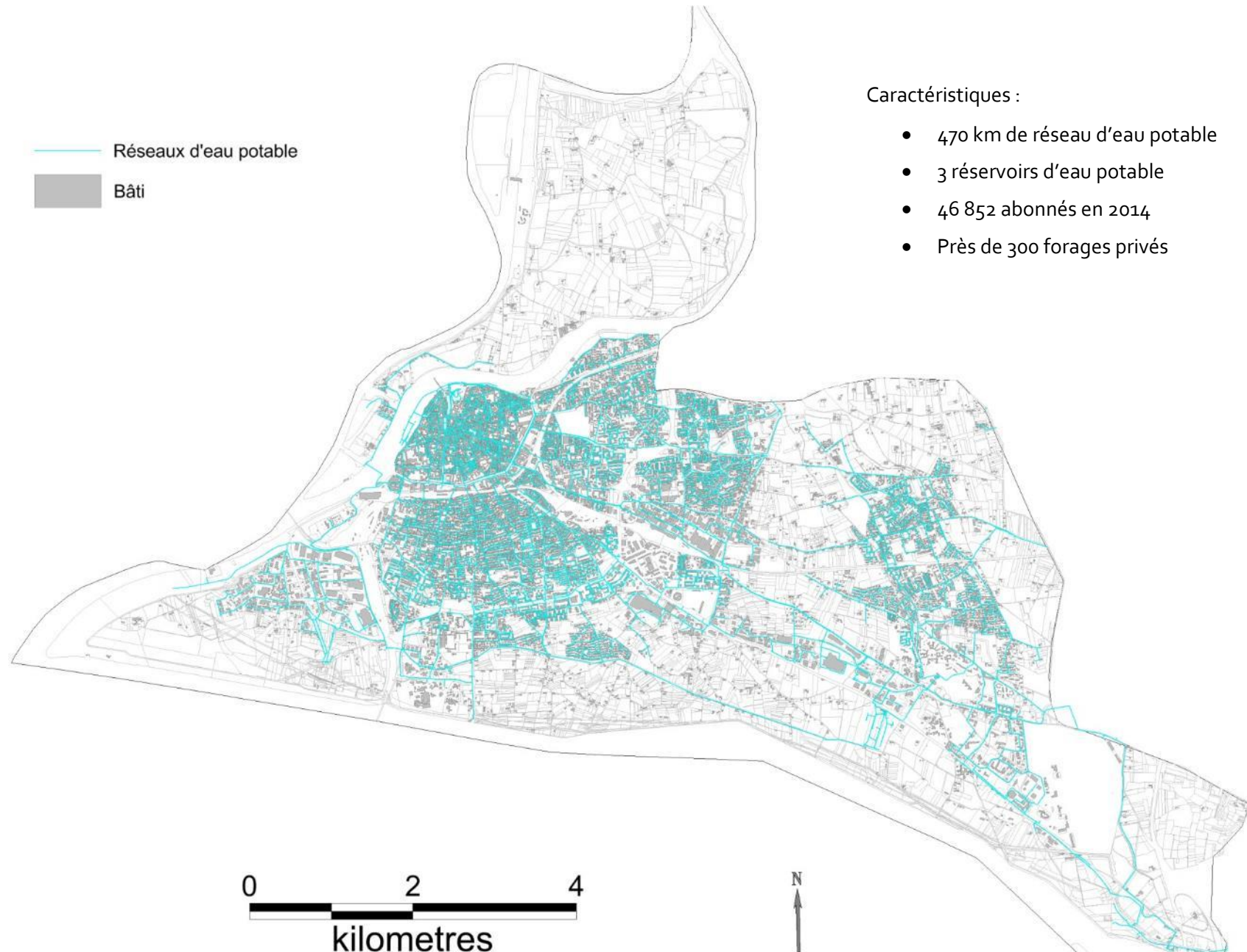
Carte : Un réseau d'alimentation en eau potable complété par le réseau de la Barthelasse Nord et des forages privés (Source : Données SIG du Grand Avignon)
